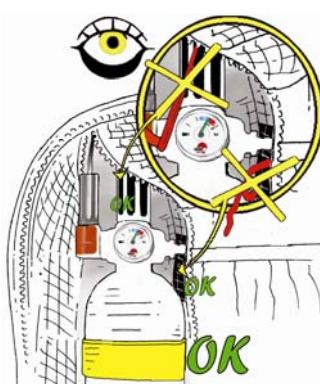
Vérifier si aucun corps étranger ne bouche les voies d'aspiration et si la cartouche est bien attachée.
