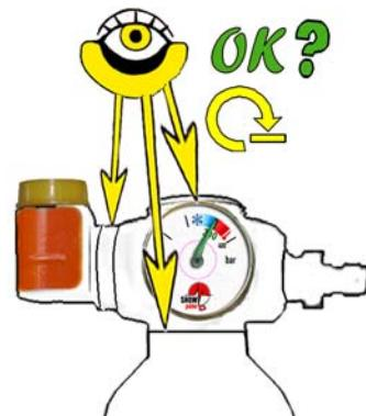
Vérifier le bon état et la fixation du mécanisme de la cartouche
