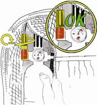
9. **Schrauben Sie das Verbindungsstück der Kabelhülle, die das Auslösekabel schützt auf den Öffnungsmechanismus**
